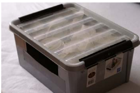
Fluekassen i funktion, bemærk udskæringen på siden dækket med kulfilter.
